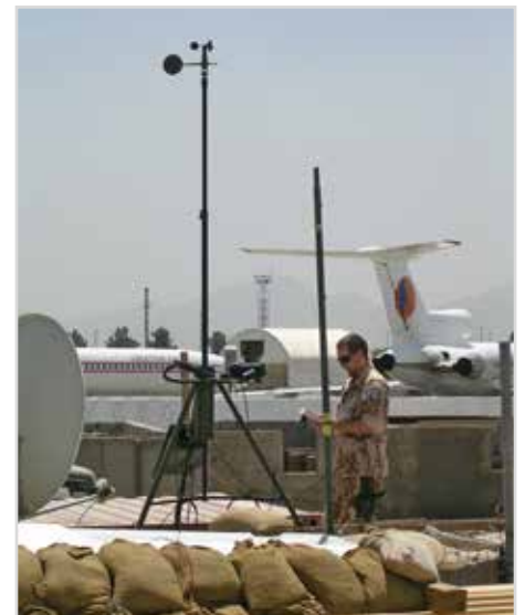
Obr. 1 Meteorologická měření s mobilní automatickou meteorologickou stanicí MAWS 201M TACMET na letišti KAIA (Kabul International Airport)
