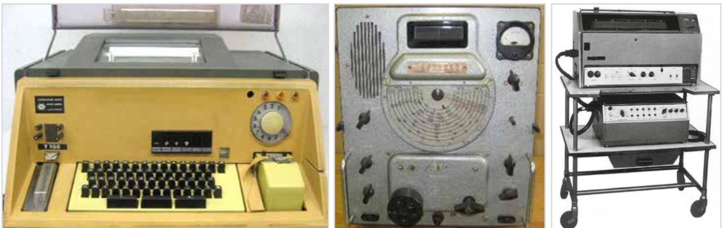
Obr. 1 Technika k přenosu textových (dálnopis stránkový T-100 [vlevo]) a grafických materiálů (přijímač fototelegrafu VOLNA-K [uprostřed]) a fototelegrafická stanice FAK-P [vpravo]) z 80. a počátku 90. let 20. století
