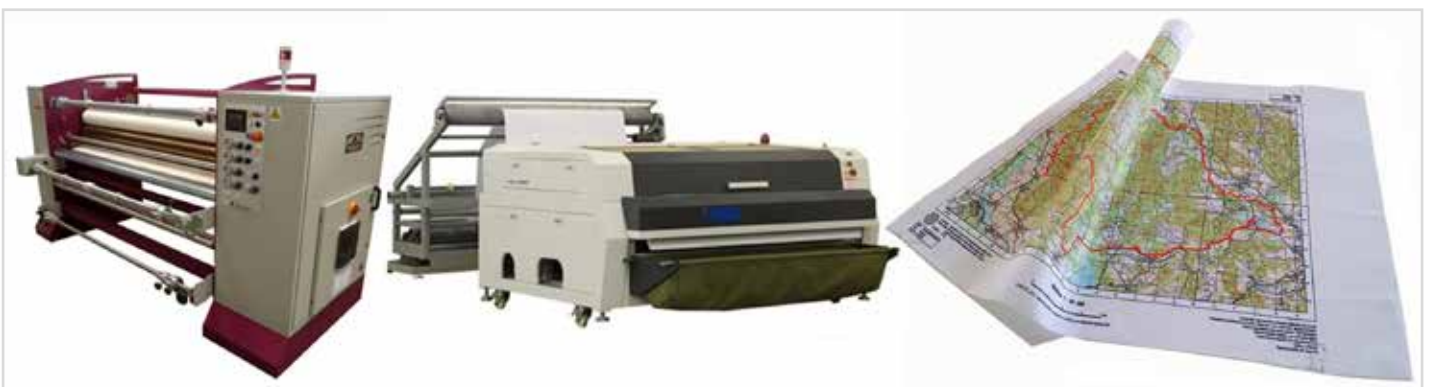
Obr. 5 Tisk na speciální materiály technologií sublimačního tisku (vlevo kontinuální sublimační lis MONTI ANTONIO Mod. 75-CFE, uprostřed řezací laser na textil HS-T1610-100S, vpravo list topografické mapy vytištěný na textilní materiál)
