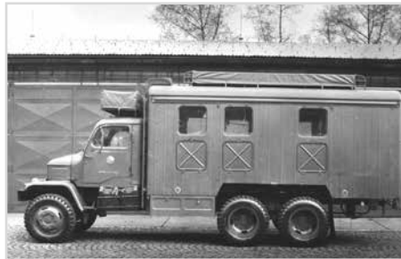
Obr. 4 Mobilní souprava GEOS na bázi štábního vozidla Praga V3S
