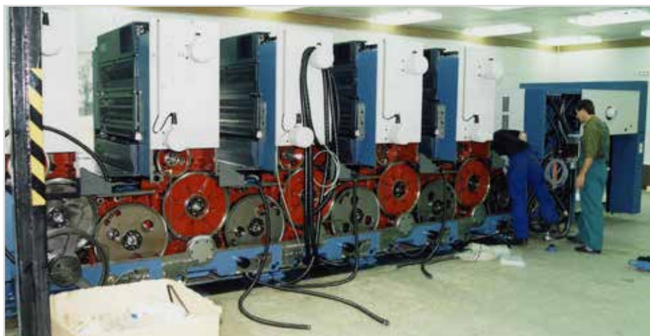
Obr. 3 Instalace tiskového stroje KBA Rapida 105 na polygrafickém pracovišti v Dobrušce
