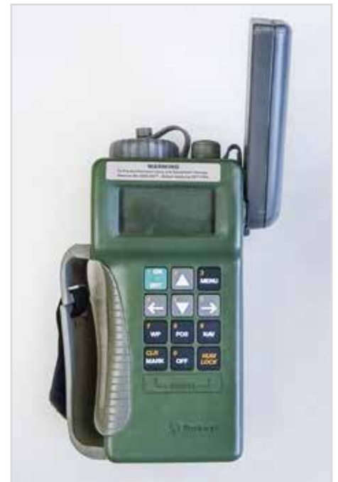
Obr. 1 První přijímači GPS PPS používanými v rezortu obrany byly PLGR +96 firmy Rockwell Collins
