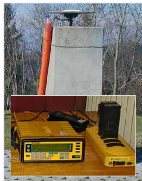
Obr. 5 Geodetický přijímač GPS Trimble 4000SSI s anténou na bodě 226 Polom
