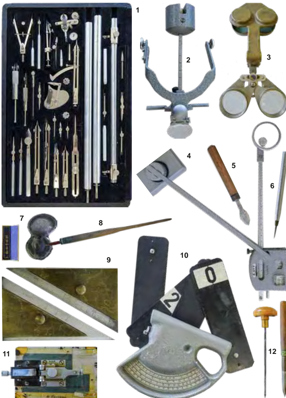
Obr. 7 Exponáty v části expozice Mapová tvorba – (1) rýsovací Prema XX, (2) rýcí vozík GT-2, (3) stereoskop Logia AN 7, (4) polární planimetr OTT 301 15, (5) šábr, (6) rýcí jehla, (7) čínská tuš a třecí miska, (8) kaligrafické pero, (9) vynášecí trojúhelníky Frič, (10) dendrometr, (11) blokoč IGS-2, (12) rydla na měděné desky
