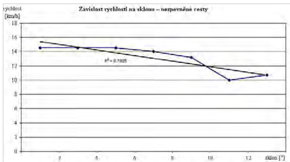
Obr. 4 Výsledky analýzy závislosti rychlosti vozidla na sklonu při pohybu na nezpevněné cestě pro ANT
