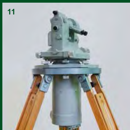
[1] tachymetr Frič, [2] teodolit Zeiss RTh II, [3] teodolit Zeiss Th 40, [4] eklimetr Kern, [5] teodolit Meopta TE D4, [6] dálkoměr AGA Geodimeter Model 8, [7] fototeodolit Zeiss 19-1318, [8] tachymetr Zeiss BRT 006, [9] teodolit Wild T4, [10] nivelační přístroj Zeiss Ni 007, [11] gyroteodolit MOM Gi-C21, [12] tachymetr Wild TC 1610
