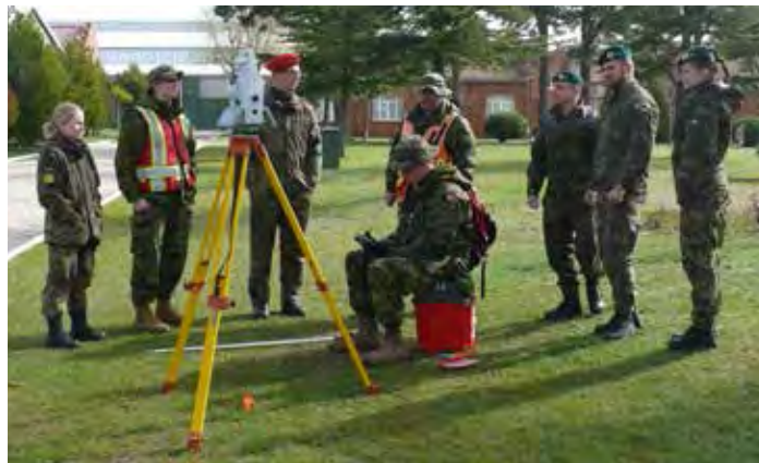
Obr. 2 Kanadská skupina při ukázce skenování výškových objektů multistanicí Leica
