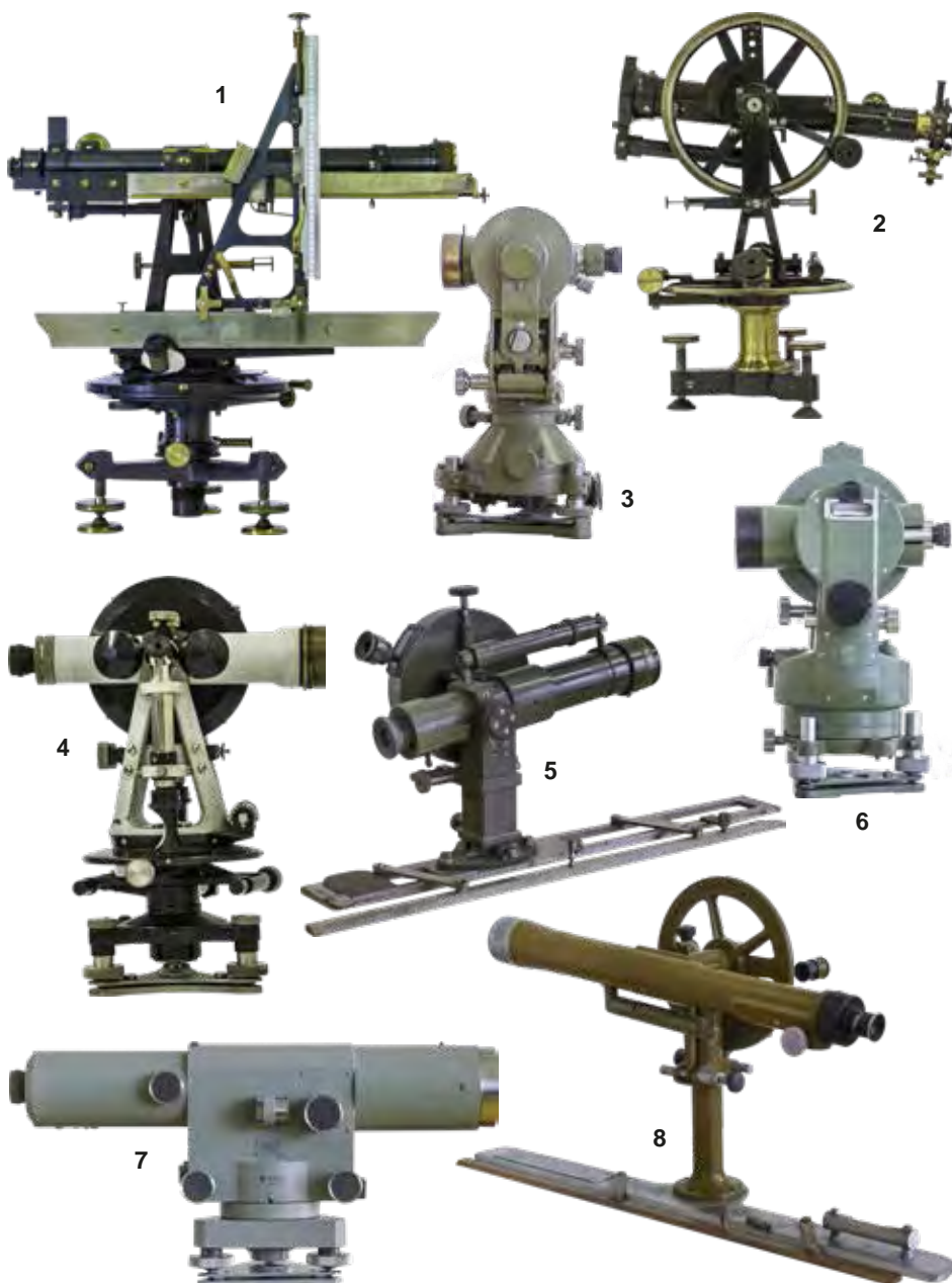
Obr. 6 Pro expozici se nám podařilo shromáždit reprezentativní sbírku historických měřických přístrojů – (1) tachymetr Fennel, (2) teodolit Starke Kammerer, (3) teodolit Wild T2, (4) teodolit Zeiss RTH II, (5) eklimet Frič, (6) tachymetr MOM Ta-D1, (7) nivelační přístroj Zeiss Ni 004 nebo (8) eklimet KB-1 (další přístroje viz zadní strana obálky)
