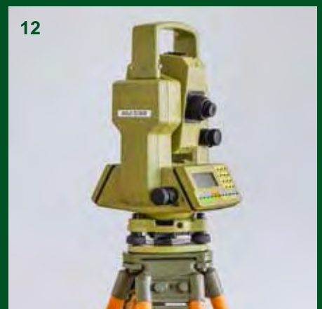
[1] tachymetr Frič, [2] teodolit Zeiss RTh II, [3] teodolit Zeiss Th 40, [4] eklimetr Kern, [5] teodolit Meopta TE D4, [6] dálkoměr AGA Geodimeter Model 8, [7] fototeodolit Zeiss 19-1318, [8] tachymetr Zeiss BRT 006, [9] teodolit Wild T4, [10] nivelační přístroj Zeiss Ni 007, [11] gyroteodolit MOM Gi-C21, [12] tachymetr Wild TC 1610
