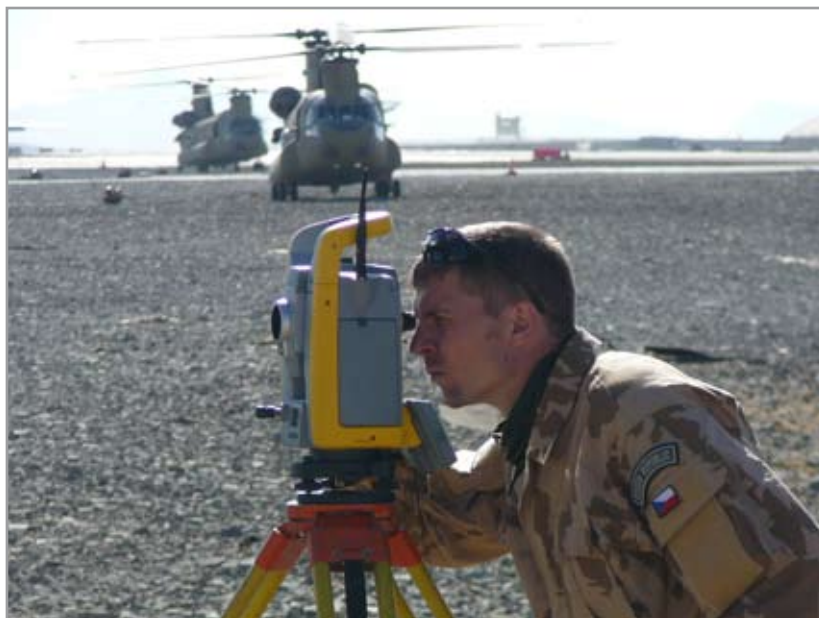
Obr. 17 Měření kompenzačního kruhu pro vrtulníkovou jednotku v Afghánistánu
