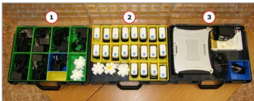
Obr. 3 Souprava pro sledování osob (1-příslušenství, 2-lokalizační jednotky, 3-klientský terminál)
