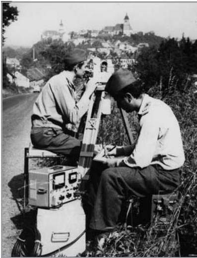
▲ Měření gyroteodolitem Gi B2
