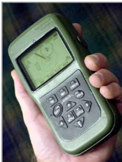
▲ Navigační přijímač GPS DAGR zavedený v armádách NATO
