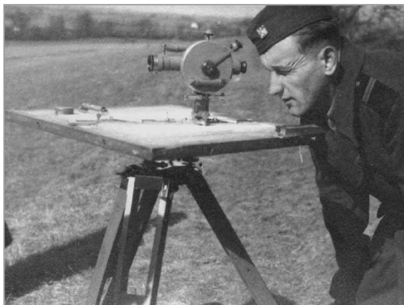
Obr. 1 Topograf Köhler při výcviku mapování stolovým tachymetrem
