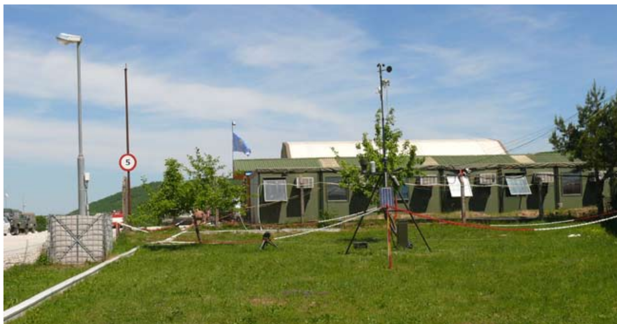
Obr. 4 Systém pro MMP MAWS 201 M TACMET na základně Šajkovac v Kosovu
