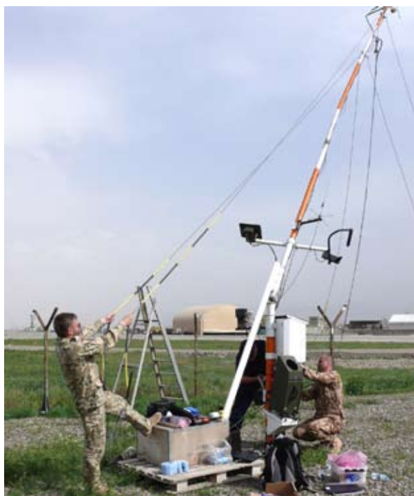
Obr. 15 Kalibrace meteorologického měřicího systému MAWS201MP na KAIA
