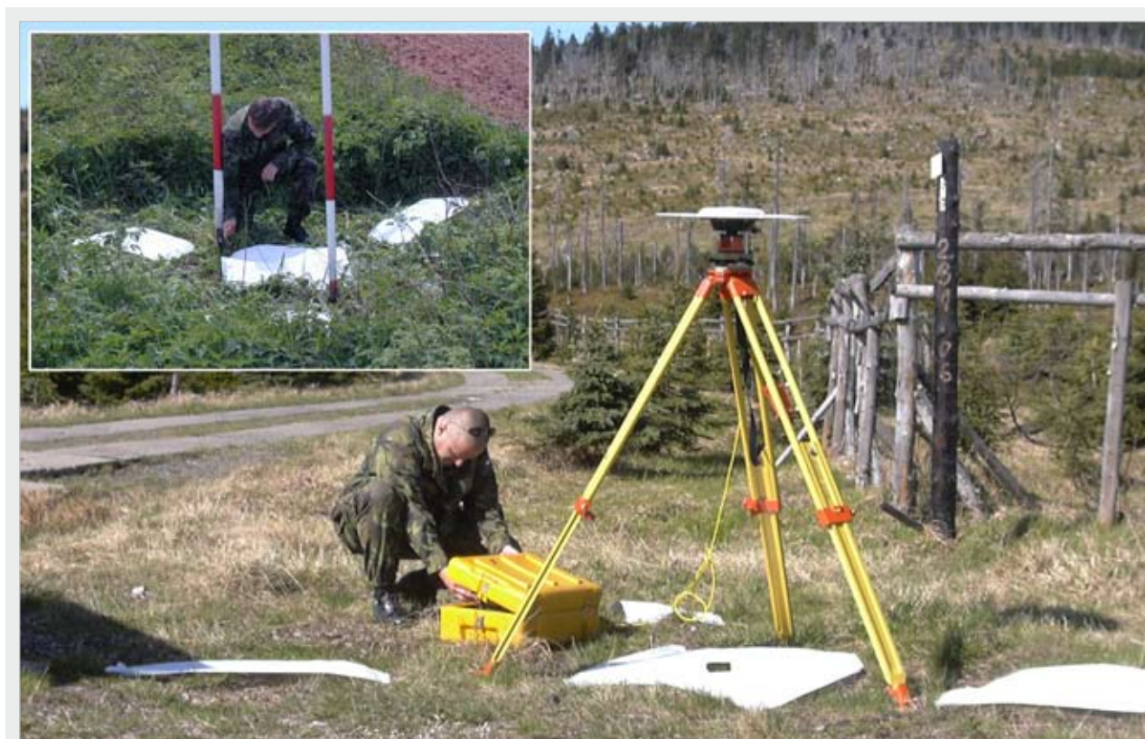
▲ Přednáletová signalizace vlíčovacích bodů s využitím tzv. geotextilie – npor. Ing. Jiří Hubička při signalizaci „volného“ bodu se současným zaměřením polohy metodou GPS (Trimble 4000SSi), vlevo nahoře pplk. Ing. Martin Kohout při signalizaci trigonometrického bodu.
