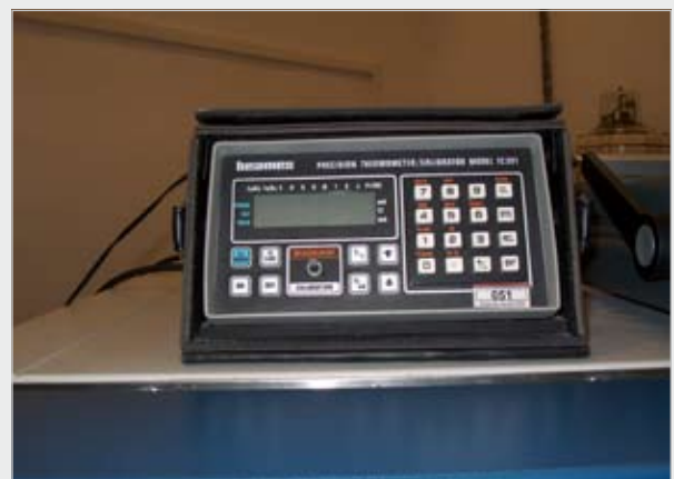
▲ Teplotní kalibrátor BEAMEX TC 301.
