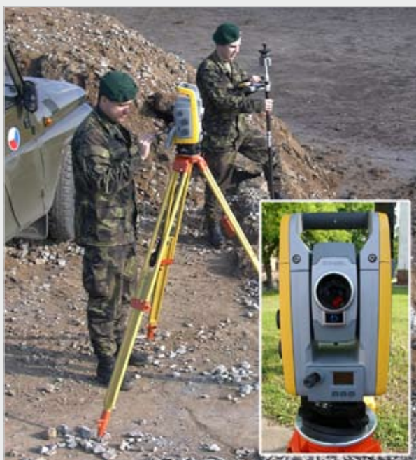
▲ Totální stanice Trimble S6 při geodetickém zabezpečení povodní postižených oblastí.
