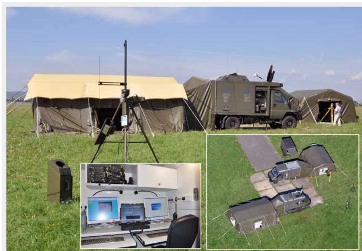
▲ Mobilní hydrometeorologická stanice BLESK a detail interiéru.
