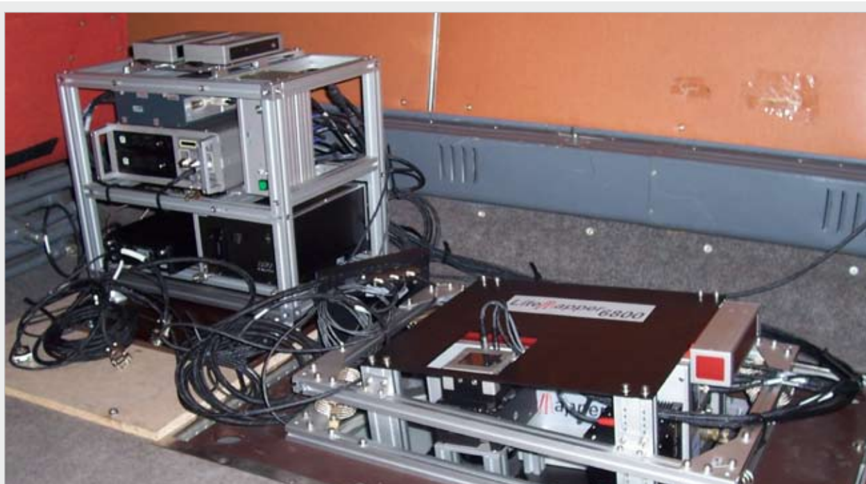
▲ Souprava laserového skeneru instalovaná na palubě letounu L-410FG.
