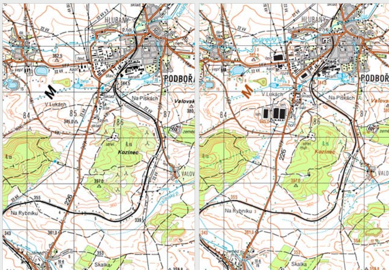
▲ Porovnání vzhledu standardizovaných topografických map měřítka 1 : 50 000 zpracovaných podle Topo-4-4 (vlevo) a Topo-4-5 (vpravo).
