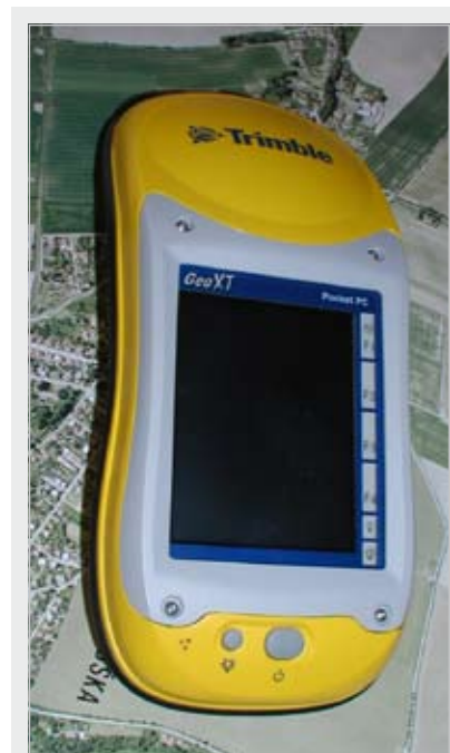
▲ Mapovací přijímač GPS Trimble GeoExplorer GeoXT.
