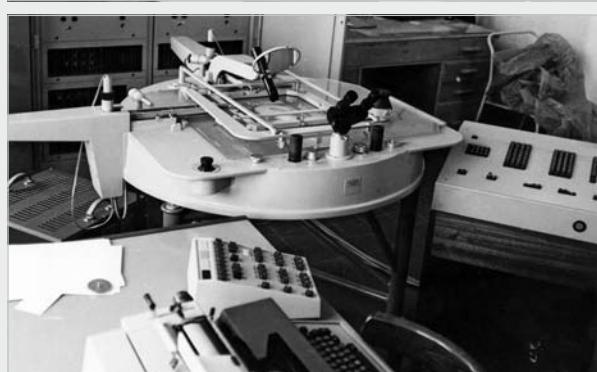
▲ Monokomparátor ASCORECORD pro měření snímkových souřadnic.
