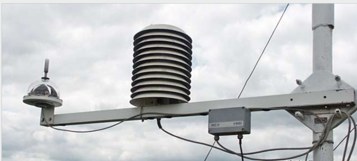
▲ Elektronický heliograf GW1 (vlevo) a čidlo PA50 (vpravo).
