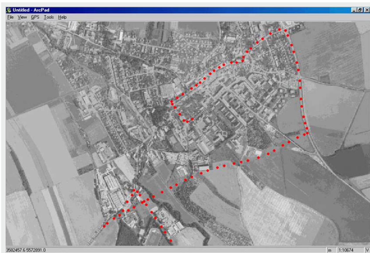
▲ Zaměření silničního obchvatu Dobrušky metodou GPS.
