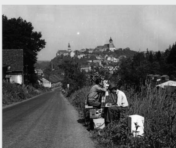
▲ Měřické práce s gyroteodolitem Gi-B1/E.
