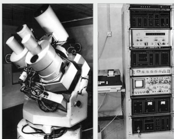
▲ Laserový dálkoměr LD-3 s ovládacím panelem na stanici Polom.
