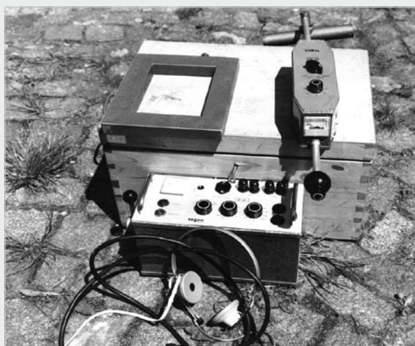
▲ Detektor podzemních inženýrských sítí ELMAG.
