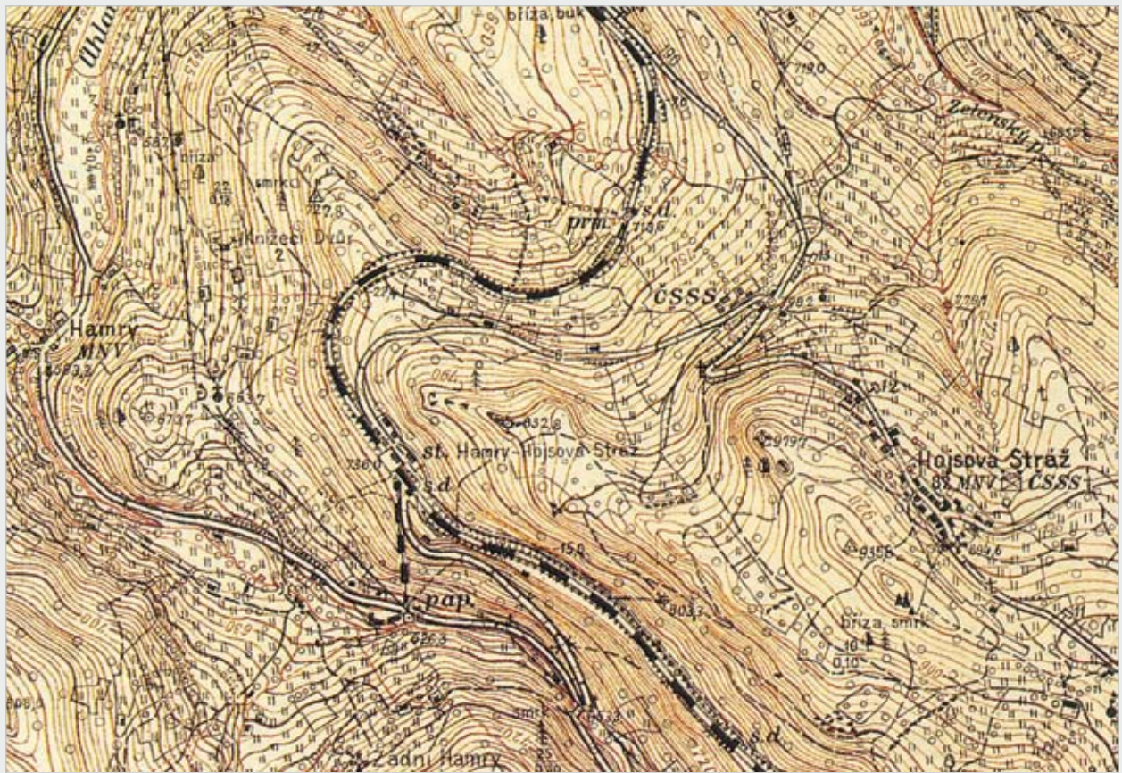
▲ Topografický originál zhotovený metodou „klasickou“ – metodou stolové tachymetrie.
