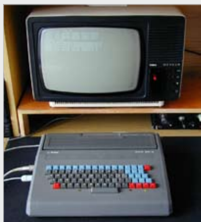
◀ Osmibitový stolní počítač Tesla PMD 85 využívající přenosný televizor jako zobrazovací monitor (ilustrační obrázek, zdroj: [46]).
