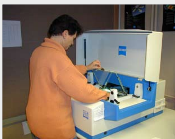
▲ První fotogrammetrický skener PCSCAI od firmy Zeiss pořízený pro Vojenský topografický ústav.
