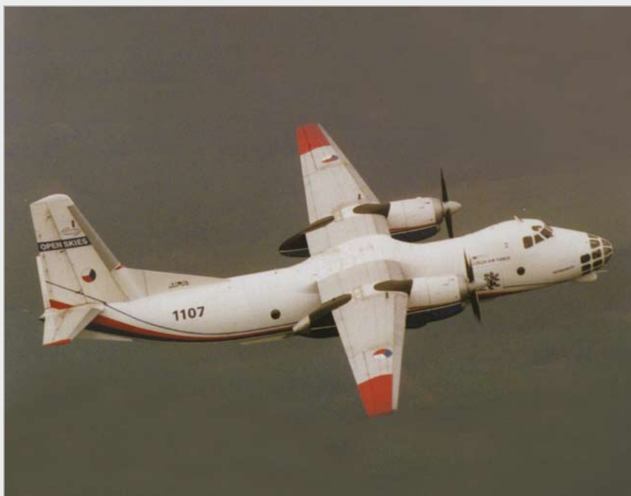
▲ V r. 1988 byl letecký park FLS rozšířen o snímkovací letoun AN-30, který zahájil letecké měřické snímkování v r. 1989.
