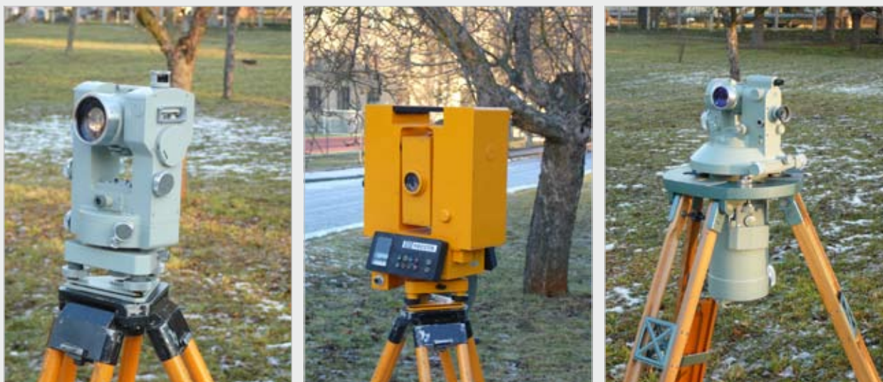
▲ Klasická geodetická technika VTOPŮ z osmdesátých let – zleva teodolit Zeiss Theo 010, elektronický tachymetr Recota a gyroteodolit Gi-B2.
