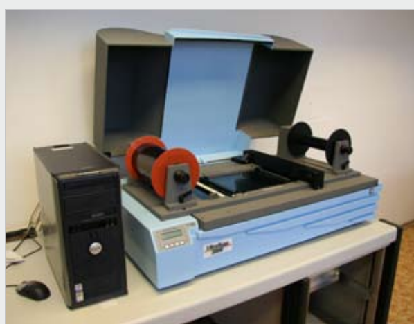
▲ Fotogrammetrický skener UltraScan 5000.
