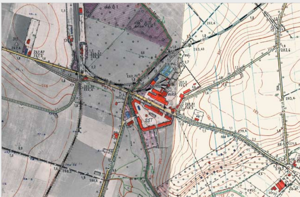
▲ Výřez topografického originálu s doměřováním stolovou metodou (zmenšeno).
