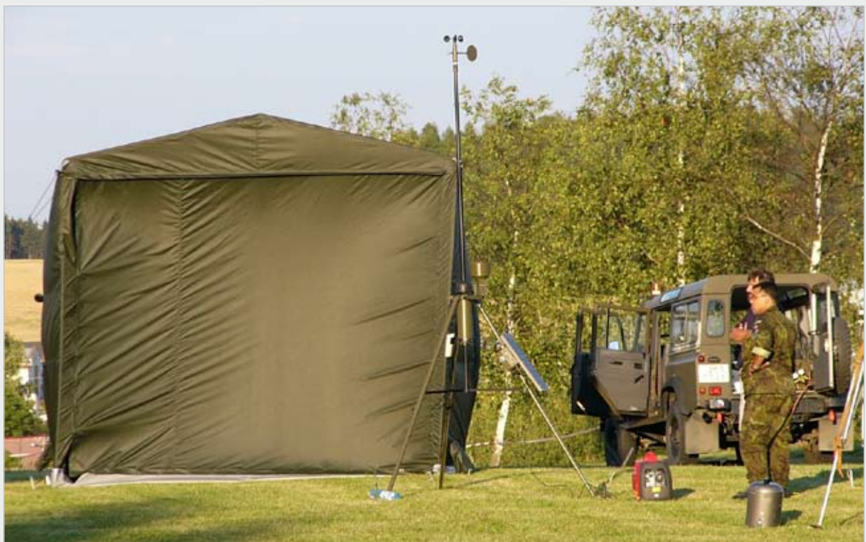
▲ Mobilní sondážní stanice se stanovým přístřeškem, stanicí MAWS-201M TACMET a automobilem LR 110.
