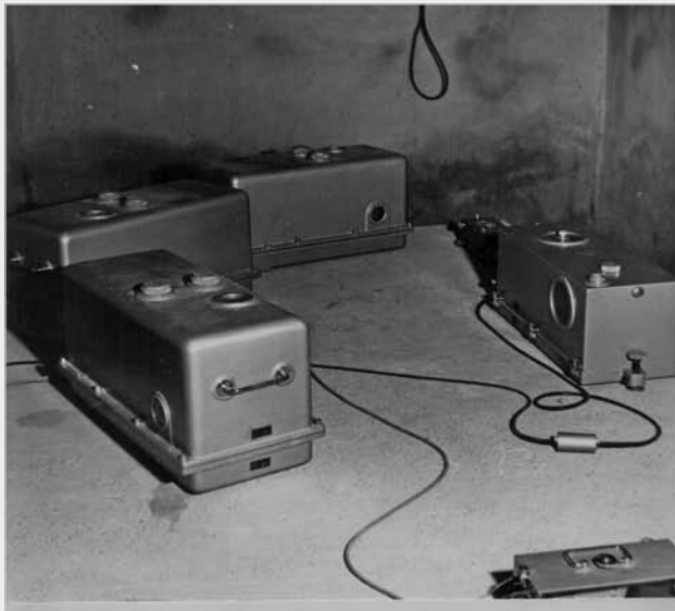
▲ Měření pro sledování neslapových změn tíhového zrychlení.
