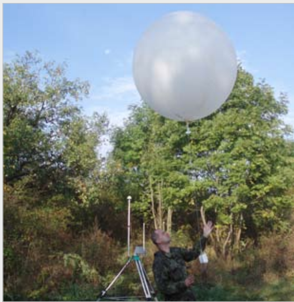
▲ Vypouštění meteorologických balónů s podvěšenou meteorologickou sondou a radiosondážní přijímač DIGICORA III.
