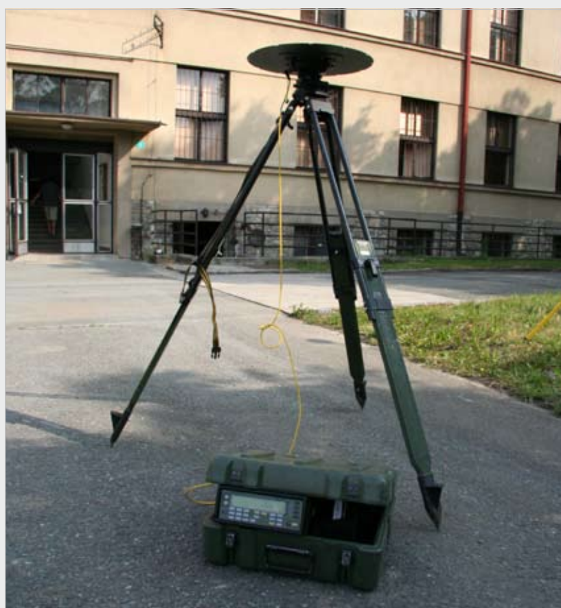
▲ Geodetický přijímač GPS Trimble 4000 MSGR.
