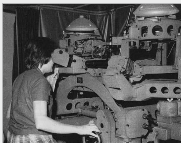
▲ Vyhodnocení polohopisu a výškopisu na univerzálním fotogrammetrickém přístroji Wild A8.
