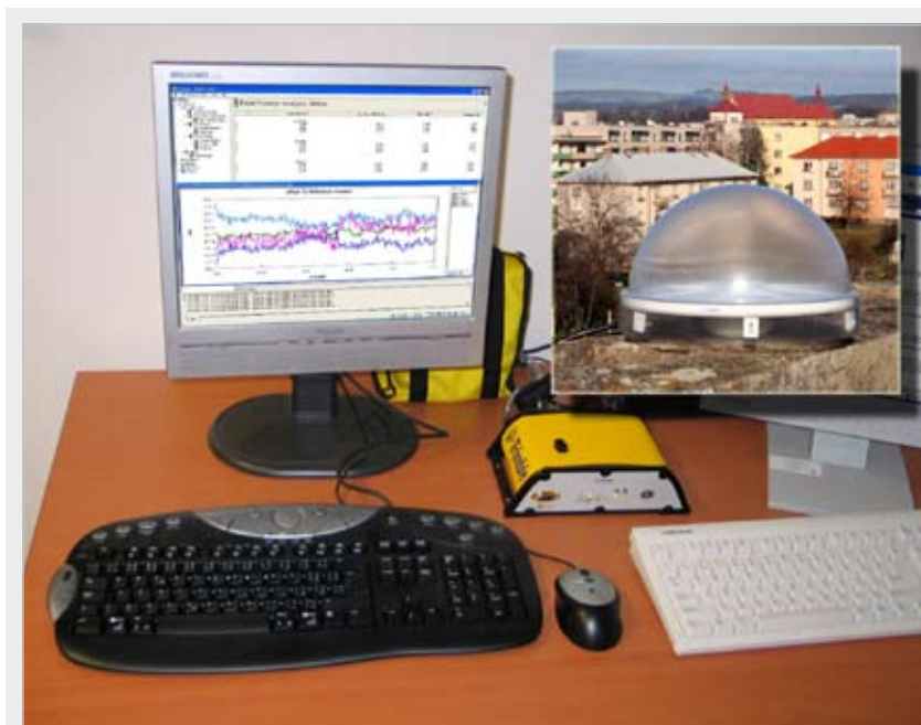
▲ Základní vybavení permanentní stanice GPS na pracovišti GISS AČR (vpravo nahoře anténa referenční stanice GPS Zephyr Geodetic, na pozadí přijímač GPS Trimble NetRS a řídicí software GPSBase).
