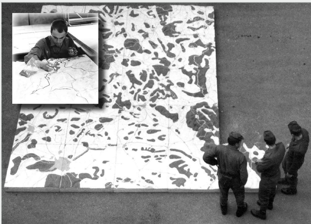
▲ K ukázkám bojové činnosti vojsk se pro vysoké vojenské důstojníky vyráběly reliéfní plastické stoly o velikosti až 20 m 2 , složené z dílů 1 × 1 m, s nosným materiálem z hobry a sádry. Na detailu kreslič při doplňování situace do plastického stolu.
