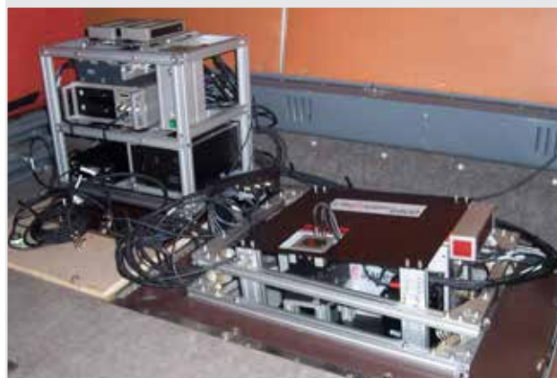
Letadlo Let L-410 FG Turbolet (nahore) a skenovací systém LiteMapper 6800 na jeho palubě (dole)
