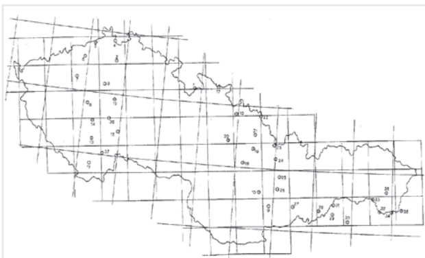
Body čs. trigonometrické sítě, pro které byly dodány souřadnice v S-42 pro převod geodetických základů z S-JTSK do S-52
