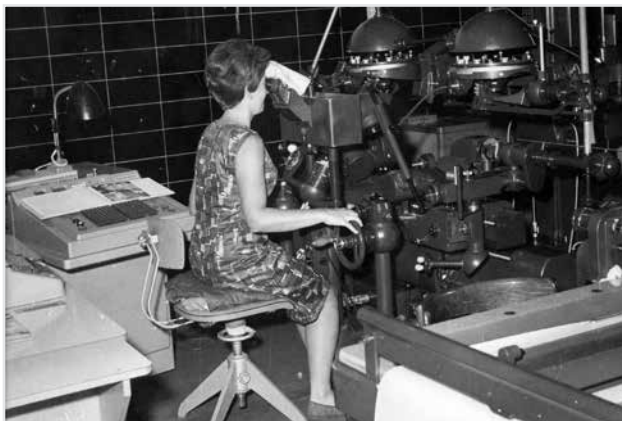
Univerzální stereofotogrammetrické vyhodnocovací přístroje Stereoplanigraf C-5 firmy Zeiss tvořily základní vybavení fotogrammetrického odboru VTOPÚ při novém mapování státu
