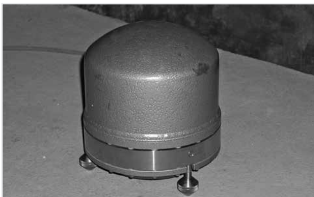
Širokopásmový zpětnovazební seismometrem Streckeisen STS-2 švýcarské výroby (na obrázku) a seismická aparatura Q52K americké firmy Quanterra nahradily v r. 1992 zastaralou sovětskou seismickou aparaturu na stanici Polom
