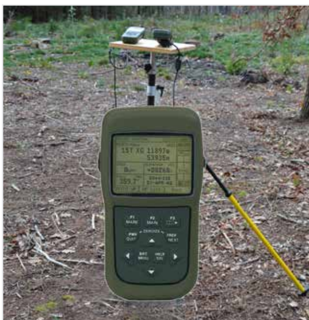
Jedním z úkolů GISS AČR je testování přijímačů GNSS zaváděných do armády (na snímku záběr z testování přesnosti přijímačů DAGR v zalesněném prostoru)
