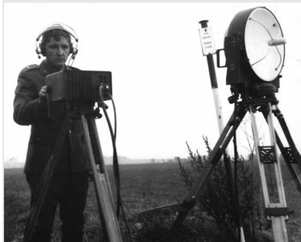
V osmdesátých letech byly rádiové dálkoměry GET-B1 (nahore) s dosahem 30 km nahrazeny rádiovými dálkoměry MT-A1 (dole) s dosahem 70 km
