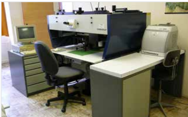
Fotogrammetrický přístroj Stereoplot firmy Carl Zeiss Jena doplněný výstupem na osobní počítač
