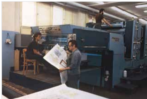
Čtyřbarvý ofsetový archový tiskový stroj VKÚ Planeta
