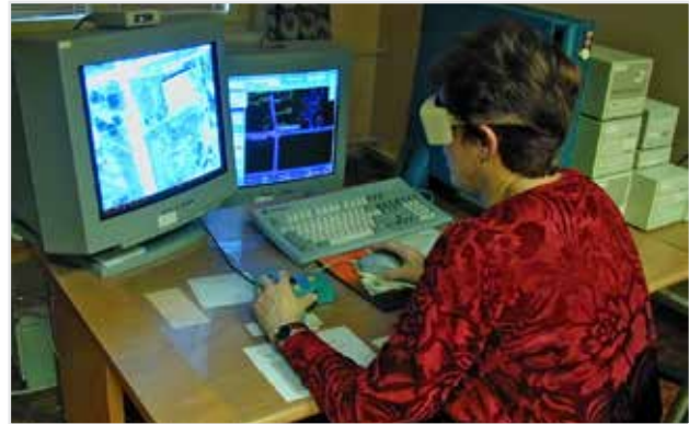
Stereofotogrammetrické vyhodnocení polohopisu a výškopisu na digitální pracovní stanici Silicon Graphics Indigo
