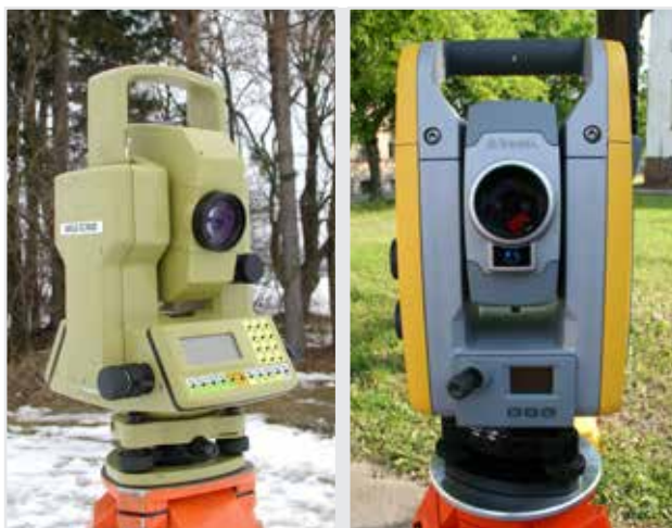
Totální stanice Wild TC 1610 (vlevo) zavedené v 90. letech byly na počátku nového milénia nahrazeny přístroji Trimble S6 (vpravo)
