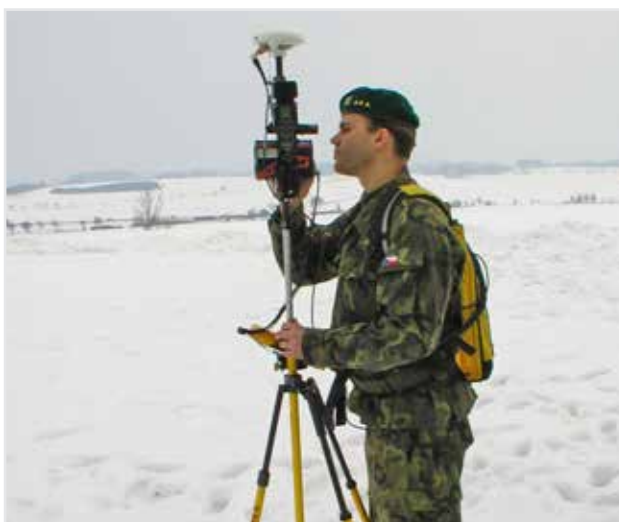
Měření výškových objektů soupravou tvořenou přijímačem GPS Trimble Pathfinder Pro XR a laserovým dálkoměrem Impulse 200 LR
