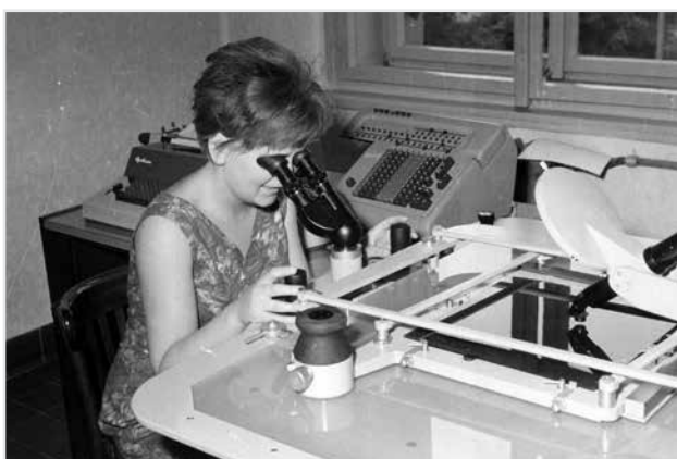
Monokomparátor ASCORECORD pro měření snímkových souřadnic
