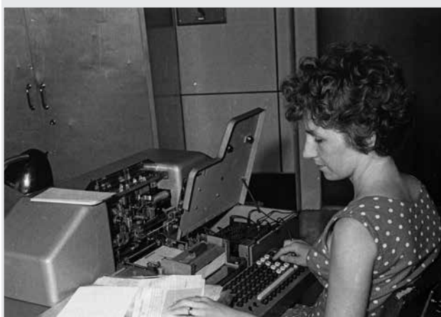
Děroštitková souprava Aritma a pracoviště děrování štitků ve VTOPÚ
