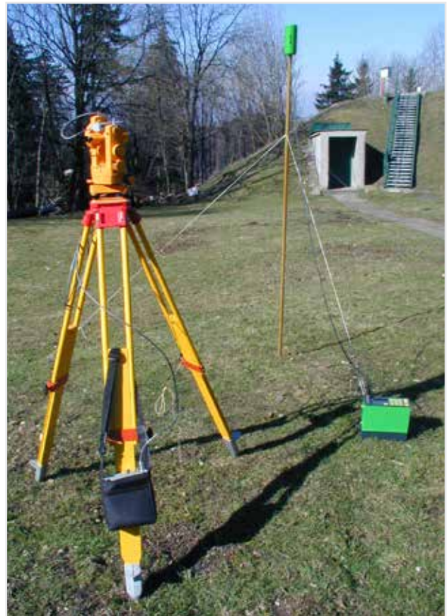
Magnetometrická souprava: vlevo Zeiss Theo 015B se sondou Bartington MAG 01H; vpravo protonový magnetometr PMG-1
