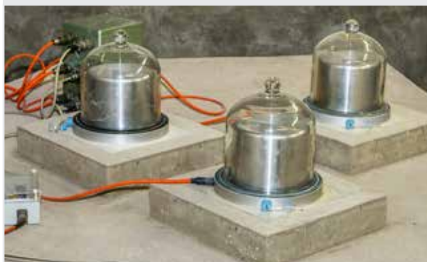
Seismická aparatura QUANTERRA Q4120 (vlevo nahoře) a seismometr STS-2 (vpravo nahoře), seismická aparatura QUANTERRA Q330HR (uprostřed) a seismometry STS-1 (dole)
