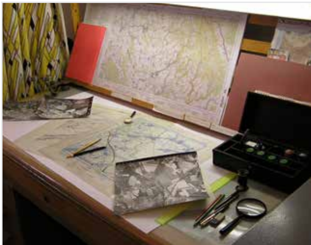
Pracoviště topografa při vyhodnocení změn klasickou (analogovou) technologií – pracovní stůl s osvětlovací rampou, revizní podklady (revizní originály polohopisu a výškopisu, zvětšenina snímku), stolní stereoskop s dvojicí snímků pro stereoskopické vyhodnocení a další potřebné pracovní pomůcky
