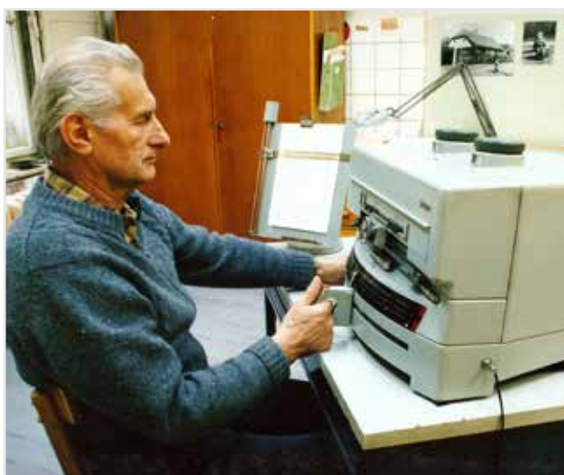
V sazbě byl ve VZÚ využíván titulkovací fotosázecí stroj Diatype
