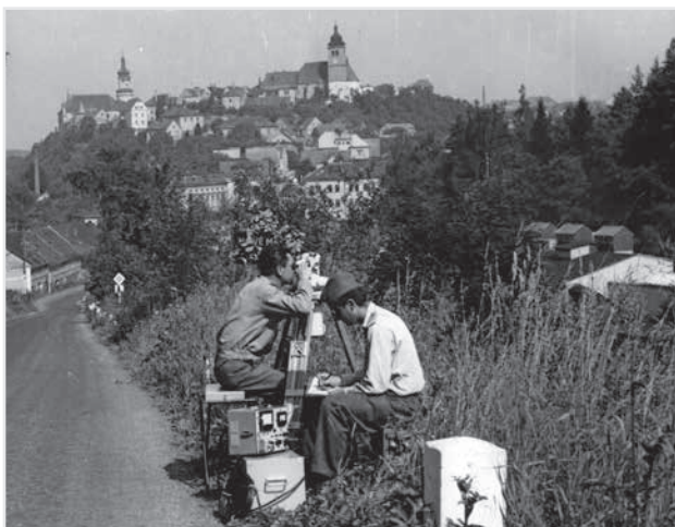
Měřické práce s gyroteodolitem Gi-B1/E
