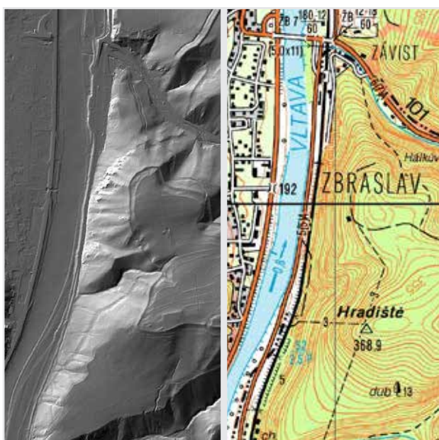
Stínovaný model reliéfu vygenerovaný z dat leteckého laserového skenování (vlevo) v porovnání s odpovídajícím výřezem topografické mapy
