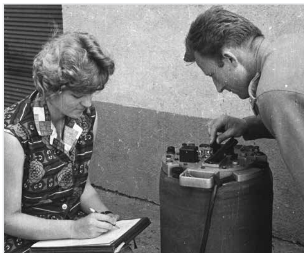
Gravimetr Askania Gs12, používaný k měření státní gravimetrické sítě
