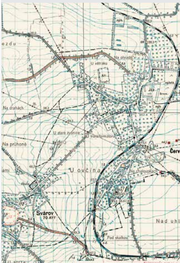
Výřezy topografického originálu s doměřováním stolovou metodou a kartografické předlohy (zmenšeno)
