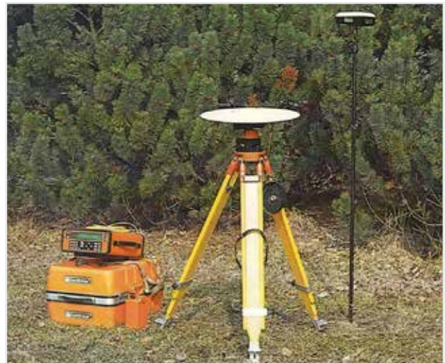
Jako první byly ve spolupráci služby a Geodetického ústavu v Praze s perspektivou společné výstavby geocentrického geodetického systému v ČSFR zakoupeny v r. 1991 tři geodetické přijímače GPS značky Geodimeter Geotracer 100
