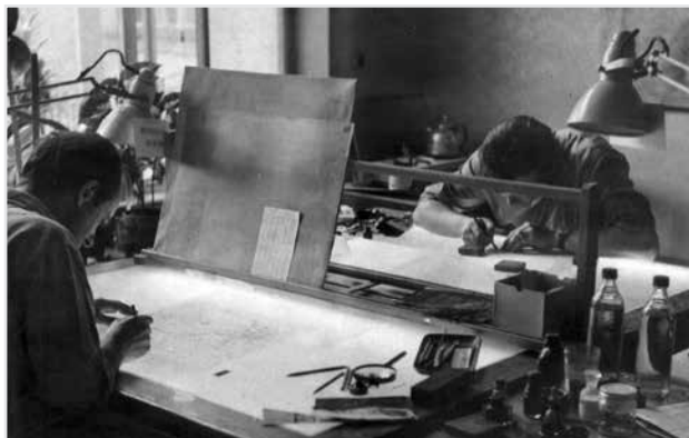
Univerzální stereofotogrammetrické vyhodnocovací přístroje Stereoplanigraf C-5 firmy Zeiss tvořily základní vybavení fotogrammetrického odboru VTOPÚ při novém mapování státu
